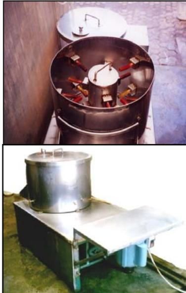
Gambar 3. Mesin pencuci empon-empon
