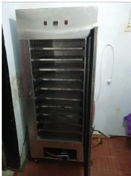
**Gambar 1. Alat pengering kabinet**
