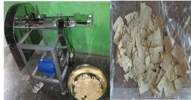
Gambar 5. Uji Coba Perajangan Tempe Menggunakan Mesin Perajang Otomatis
