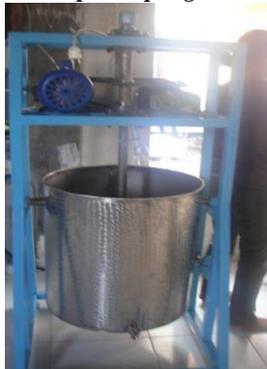
Gambar 5. Tangki pemasak dengan pengaduk otomatis
