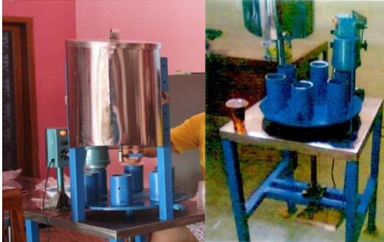
Gambar 4. *Cup sealer* semi otomatis dengan tangki penampung
