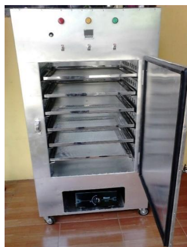
Gambar 2. TTG Alat Pengering Mekanis Model Green House yang dikembangkan dalam keadaan terbuka dengan 6 rak
