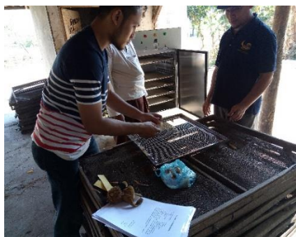
Gambar 8. Menyiapkan bahan ikan tembang putih basah yang akan diproses pengeringan dengan TTG Alat Pengering Ikan Mekanis Model Green House
