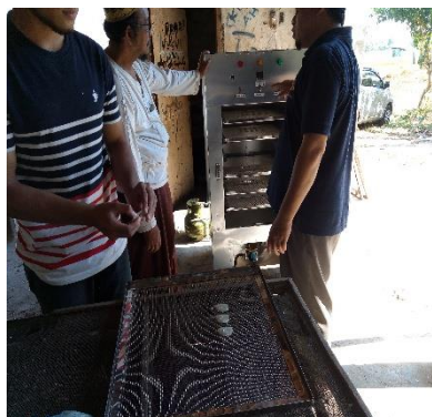
Gambar 12. Memasukkan rak bahan yang sudah terisi bahan ikan tembang putih
