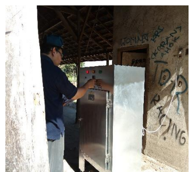
Gambar 13. Menekan saklar "POWER" dan mengatur suhu pada 70° C
