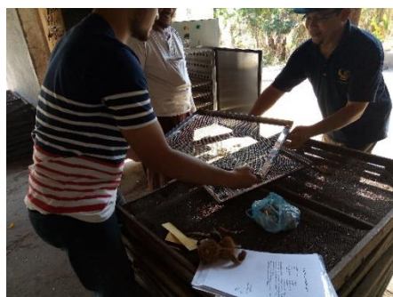
Gambar 10. Meletakkan bahan yang akan dikeringkan pada rak-rak pengering.
