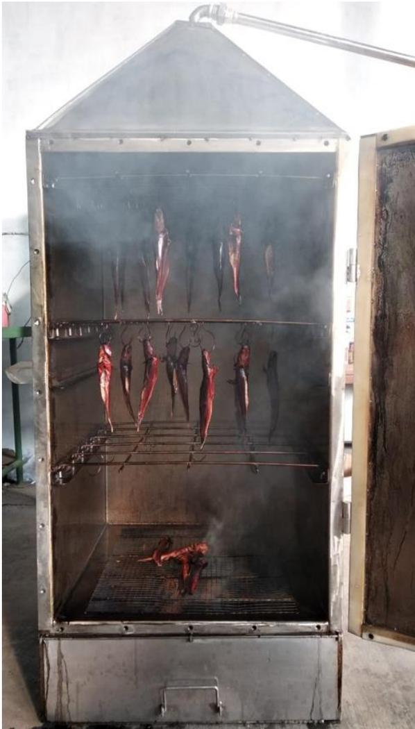
**Gambar 2. Teknologi mesin pengasap ikan sistem tertutup**
