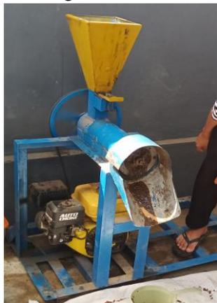
**Gambar 6. Alat yang digunakan Pencampuran Bahan & Pencetakan Pellet**
