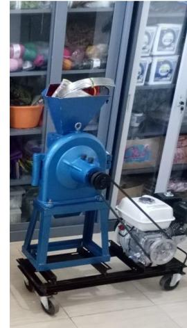
**Gambar 4. Disk Mill : 50-100 mikron**
