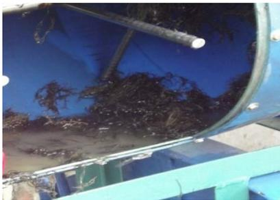
Gambar 2. Bagian dalam drum pencuci
