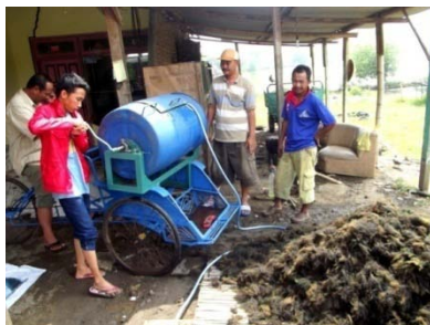
Gambar 3. Pencucian rumput laut dengan drum pencuci
