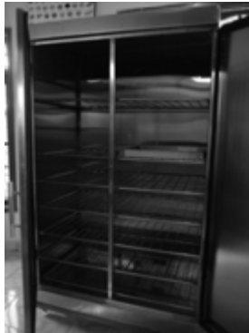
Gambar 2. Proofer untuk pengembangan adonan roti
