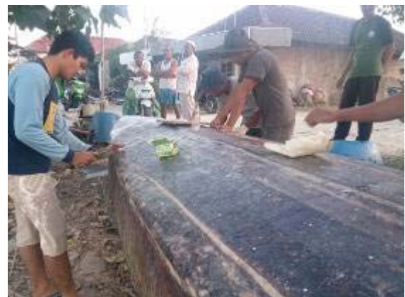
Gambar 5. Pemakuan lapisan fiberglass pada lambung kapal
