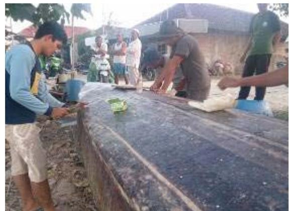
Gambar 5. Pemakuan lapisan fiberglass pada lambung kapal
