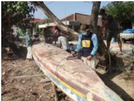
Gambar 3. Pembersihan lambung kapal
