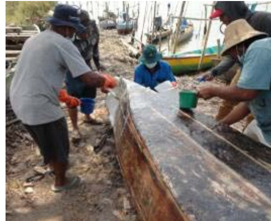
Gambar 4. Pelapisan serat fiberglass pada lambung kapal
