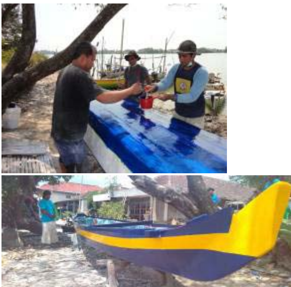
Gambar 7. Pengecatan dan finishing
